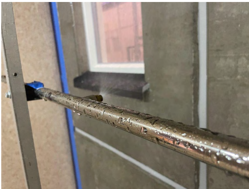
2. Pågående provning. Detaljbild av pågående vattenexponering.
