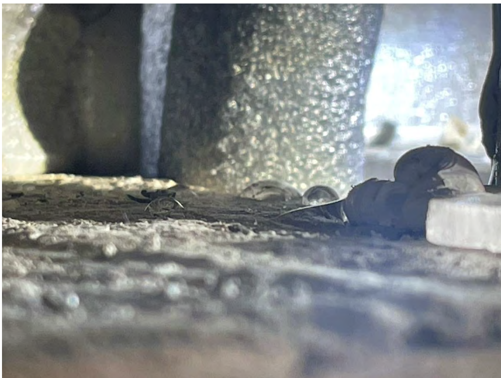
9. Pågående provning (SS-EN 12865:2001) L5. Skvätt förbi TDV- 4, överlappsfog. Vid 0-150Pa, Steg 3.
