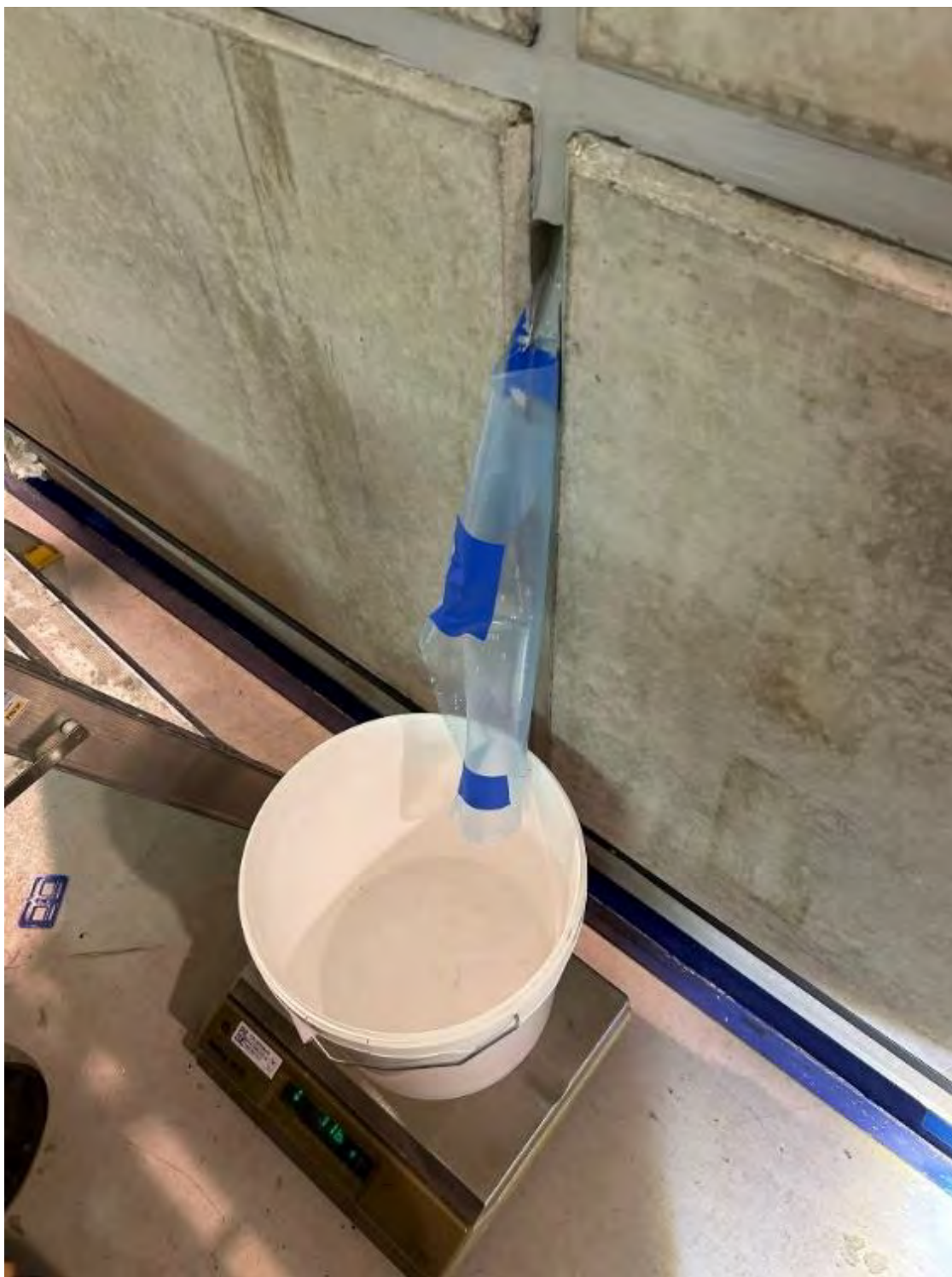
18. Vid pågående provning (Indikationsprovning 1.). Vatten dränerar ut genom TDV-öppningen.
