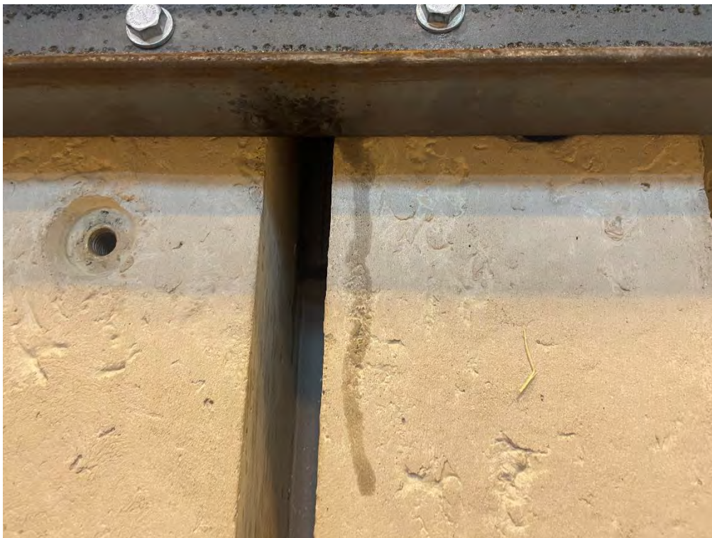
15. Pågående provning (SS-EN 12865:2001) L9. Vatten som följer med pulserande luftflöde genom TDV-1 och som rinner ner på insidan av betongskivan. Vid 0-300Pa. Steg 6.
