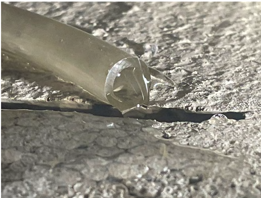
18. Pågående provning (indikationsprovning 2). Påfört vatten mellan yterskiva och isolering under dränagetest.
