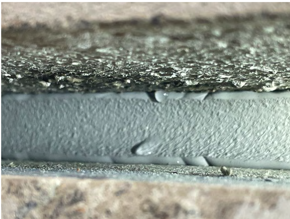
8. Pågående provning (SS-EN 12865:2001) L4. Överkant mjukfog. Vid 0-75Pa, Steg 2. Rå betongyta i överkant där ballasten är synlig.
