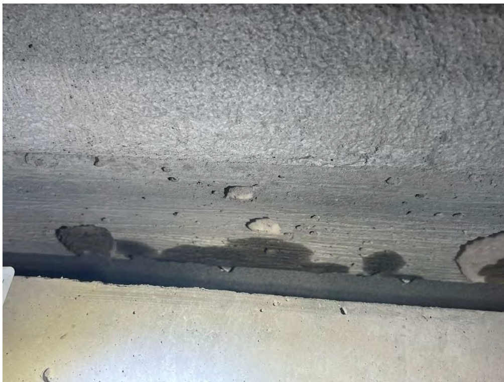
11A. Pågående provning (SS-EN 12865:2001) L11. Ovansida balkong. Ovansida fogband. Vid 0-150Pa, Steg 3.
