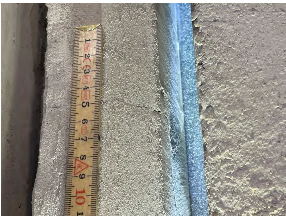
7. Pågående provning (SS-EN 12865:2001) L3. Genomgående spricka. Centimeterstock som storleksjämförelse. Sprickan uppmättes till 0,1-0,15 mm på fasadsida. Sprickan noterades i samband med mottagningskontroll och hade uppkommit före ankomst till RISE.
