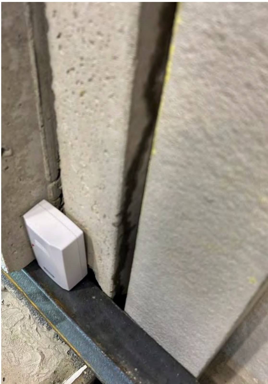
2B. Pågående provning (SS-EN 12865:2001) Vatten från L2 och L15 -vertikalfog. Vattnet rann nedåt och mot insidan av den yttre betongskivan, vid 300 Pa för steg 4.
