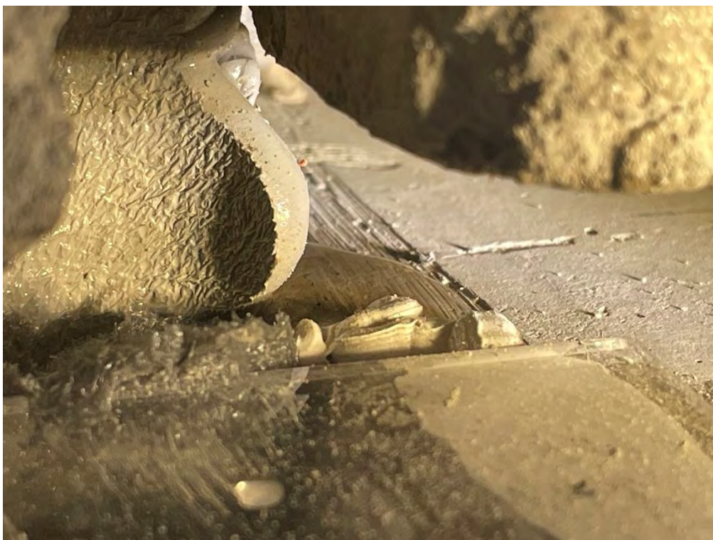
10. Pågående provning (SS-EN 12865:2001) L6. Vatten/skvätt vid sidan av TDV-3, överlappsfog. Vid 0-150Pa, Steg 3.
