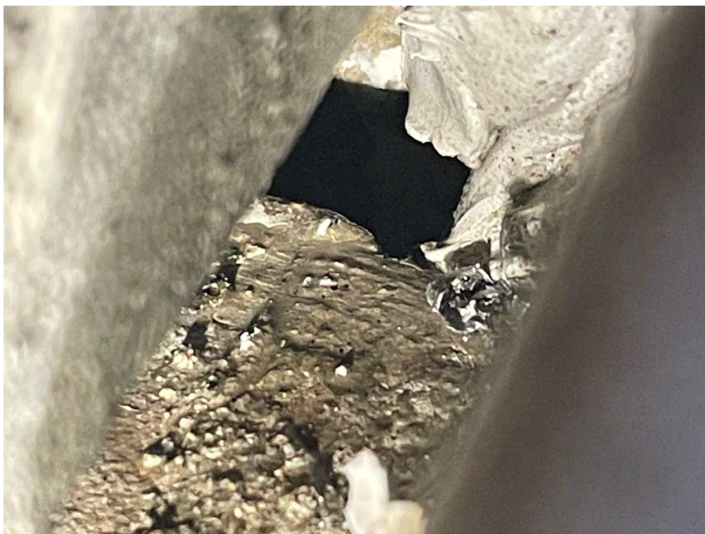
8. Pågående provning (SS-EN 12865:2001) L8. TDV-öppning, (TDV-2). Vatten skvätter upp ur TDV-öppning och in i rännan. (ej klassat som läckage under Steg 3 men skvätter över in på betonginnerskivan under steg 6). Bild vid 0-150Pa, Steg 3.
