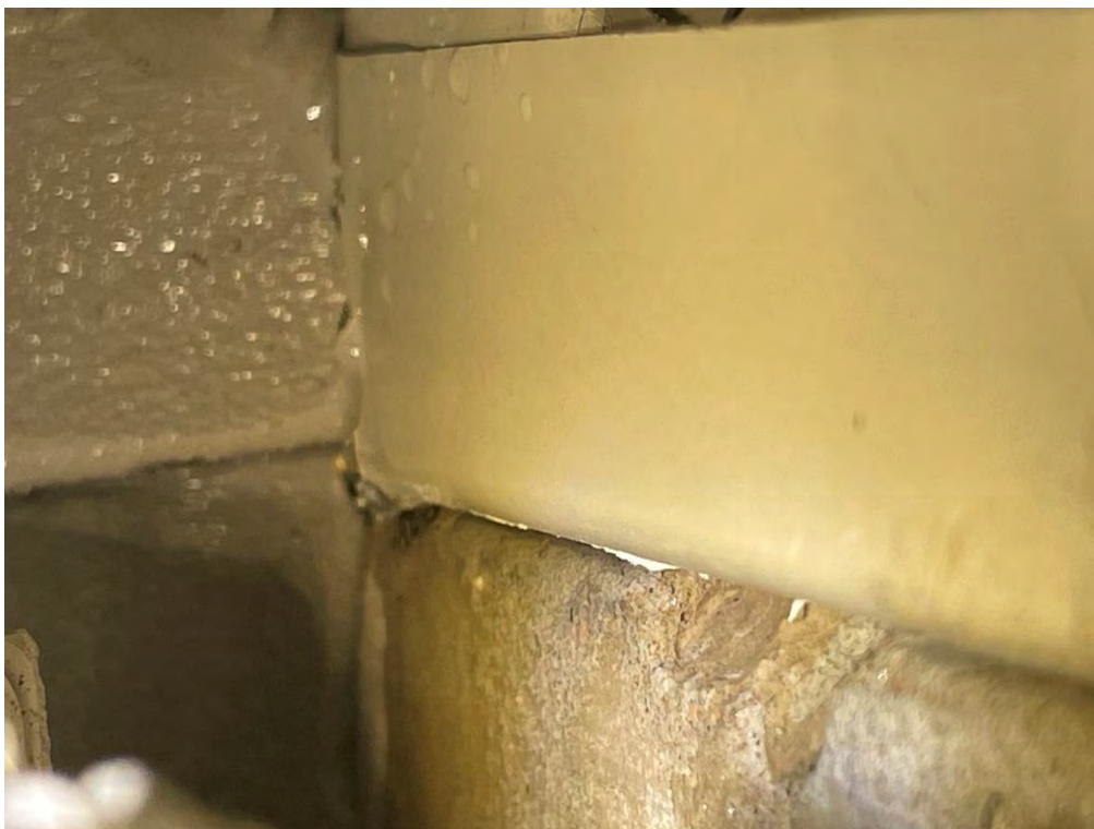
12. Pågående provning (SS-EN 12865:2001) Närbild L7, vänster sida.
