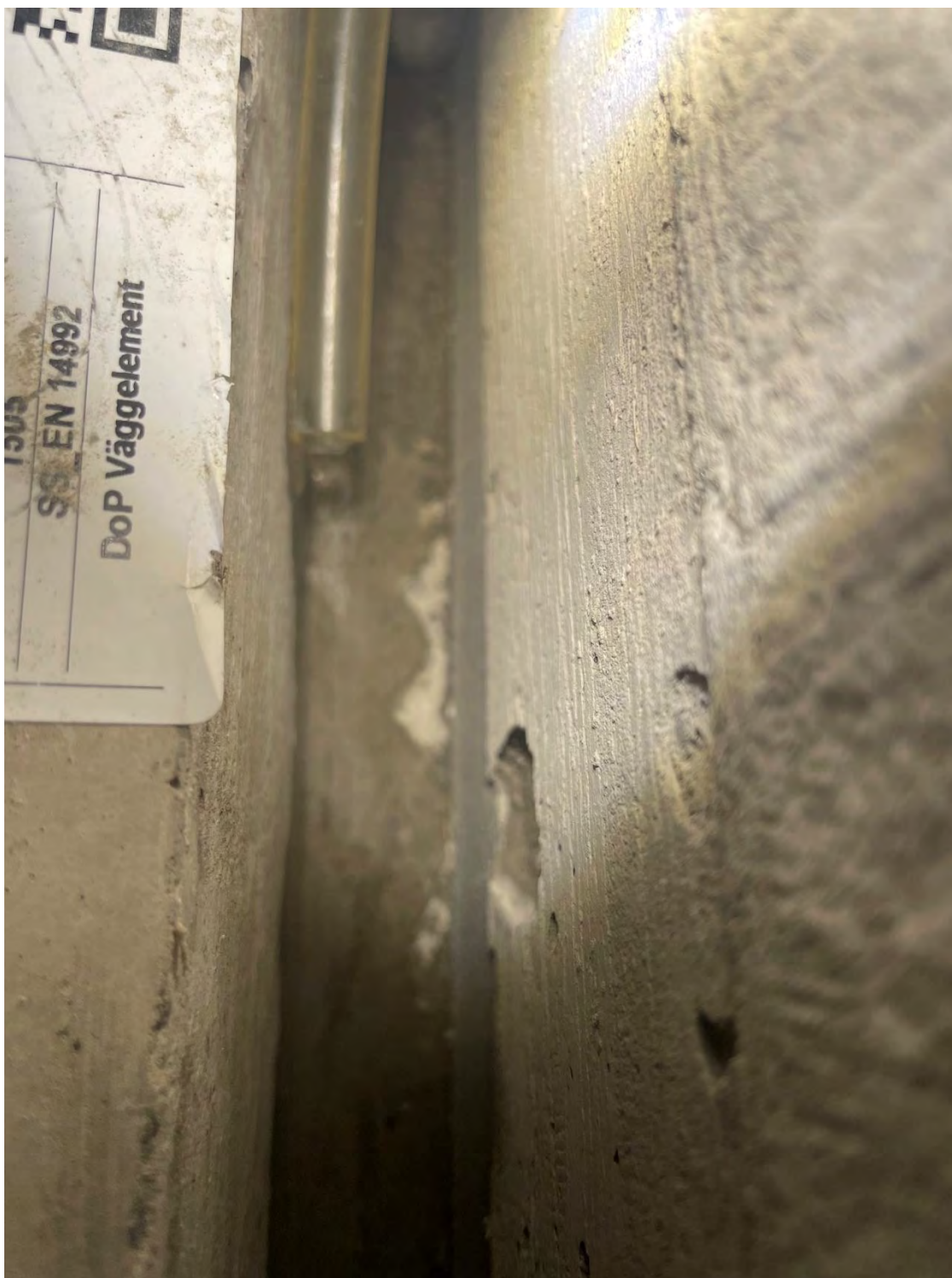
18. Indikativt funktionsprovning 3. Påfört flöde i horisontell elementskarv/fals under 12 timmar.
