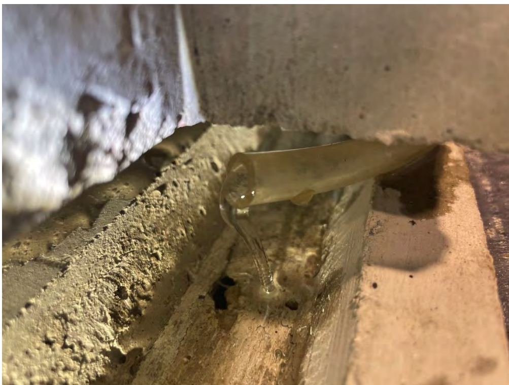
16. Pågående provning (indikeringsprovning 1.) Kontrollerat vattenflöde påförs i rännan.
